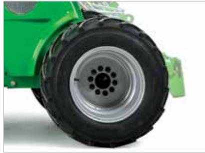
Toplamda 4 Adet Hidrostatik Yürüyüş Motoru
