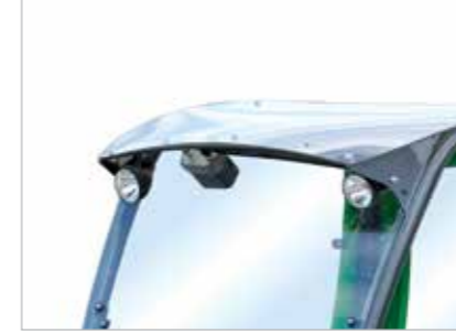
Ön Üst Çalışma Lambaları (LED, 700 lumen)
