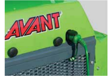
Soğuk Havalarda Buz Eritici Motor Blok Isıtıcısı
